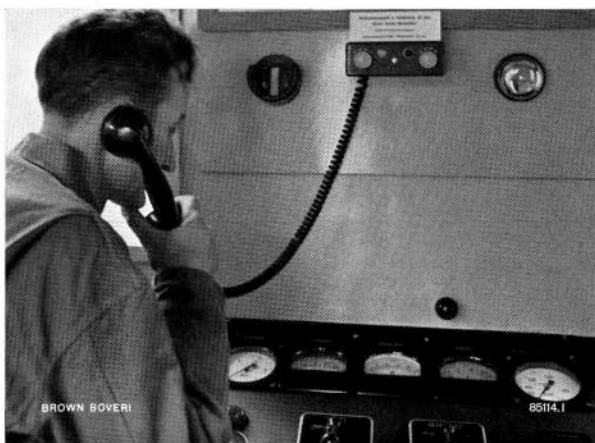
Bild 6 – Mit dem Radiotelephon in der Rangierlokomotive wickelt sich der Rangierdienst flüssiger und sicherer ab
