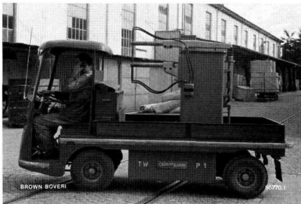
Bild 7 — Wirtschaftlicheres internes Werktransportwesen durch drahtlose Einsatzlenkung der Karren, Lastwagen, Hubstapler und Krane
