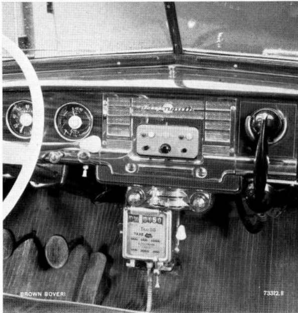
Bild 8 — Das Radiotelephon im Taxameter erspart Leerkilometer und verkürzt die Wartezeit der Fahrgäste
