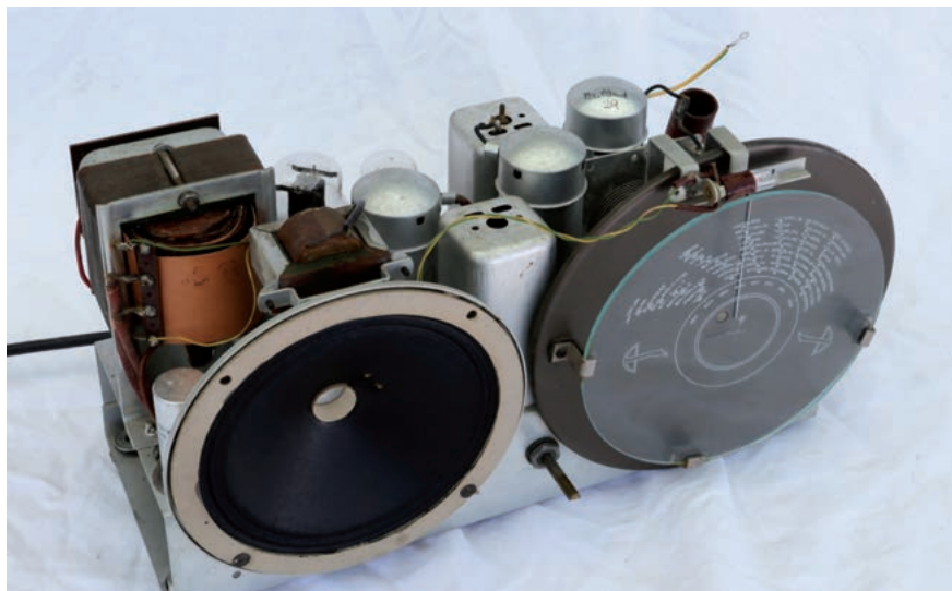
Im Bild links der neu beschichtete Lautsprecher, direkt dahinter vor dem Netztrafo der Siebkondensator für die Anodenspannung. Rechts die Skala mit Beleuchtung, in der Mitte der Lautstärkereglер.
