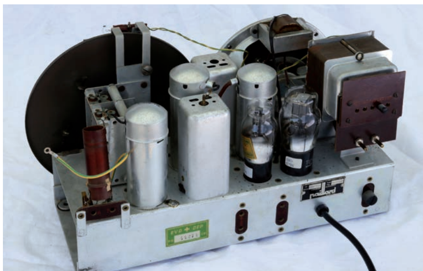
Das Bild zeigt den kompakten Aufbau, links die Eingangsspule, dahinter der Doppeldrehkondensator und rechts in der Abschirmhaube die 6J8G. In der Mitte die 6D6 und die 75, beide in Abschirmhauben, und die beiden ZF-Bandfilter. Davor die kleine Endröhre 41 und der Gleichrichter 80. Ganz rechts der Netztrafo und dahinter der Lautsprecher mit Ausgangstrafo.
