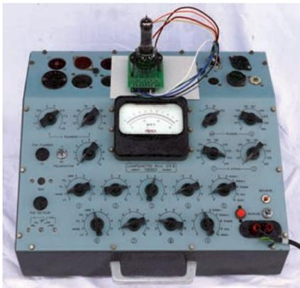
Bild 5: METRIX Röhrenmessgerät mit Tastadapter
